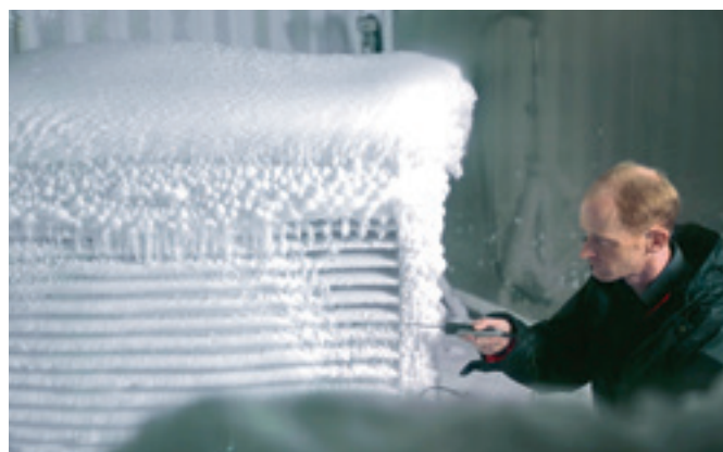
Klimatické komory simulují různé provozní podmínky.
